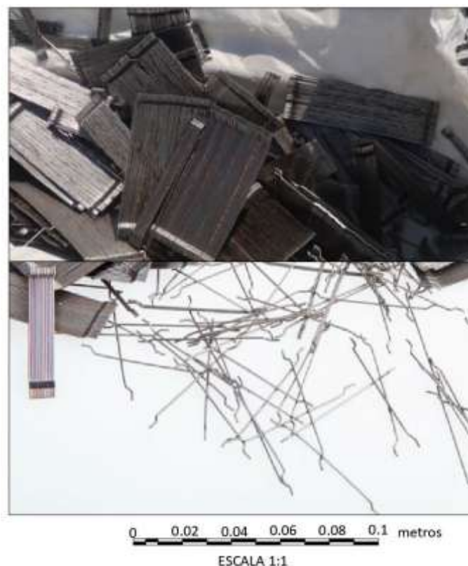
Figura 4. Fibra de acero trellado de alta resistencia SIKA® FIBER CHO 80/60 NB (escala 1:1)
