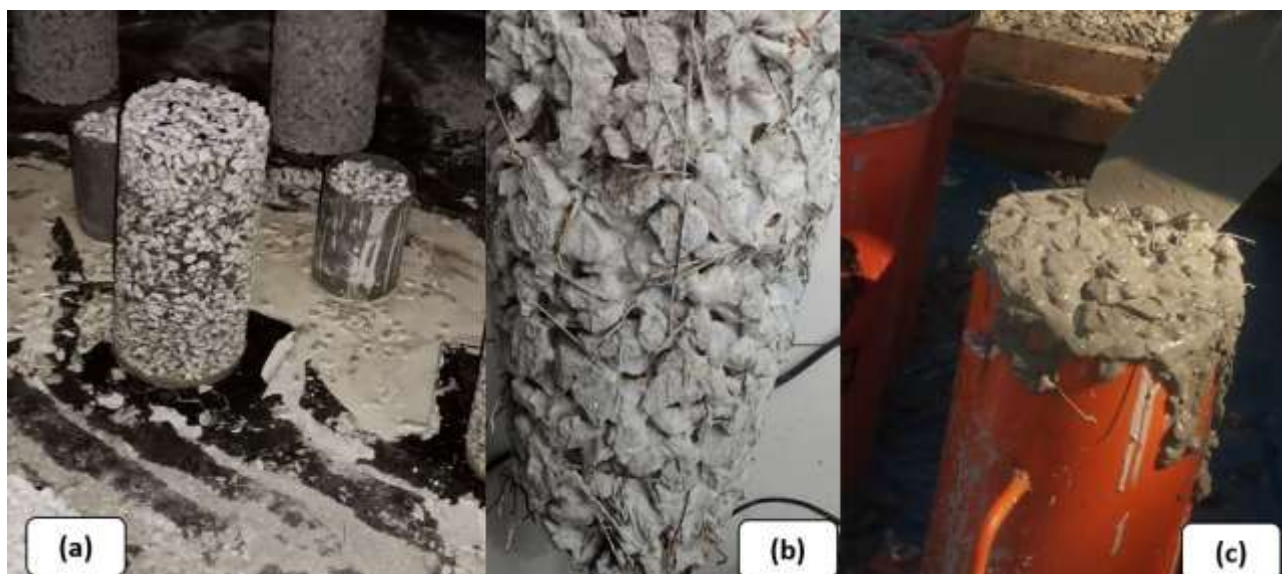
Figura 10. Textura de especímenes cilíndricos — Etapa II: (a) sin fibras, (b) con fibras, (c) proceso de llenado
