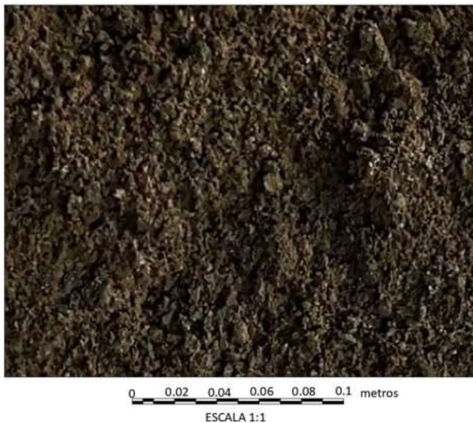
Figura 3. Agregado fino de cantera «Arenera Jaén» (escala 1:1)
