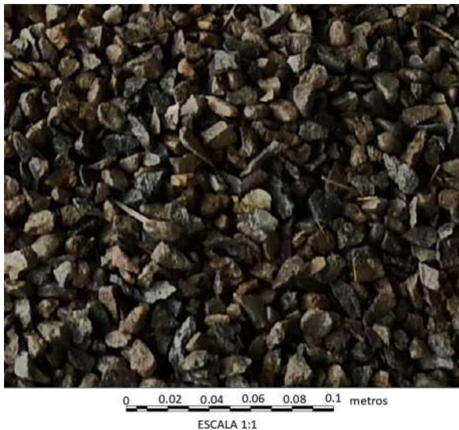
Figura 2. Agregado grueso de cantera «Arenera Jaén», huso granulométrico N° 67 (escala 1:1)
