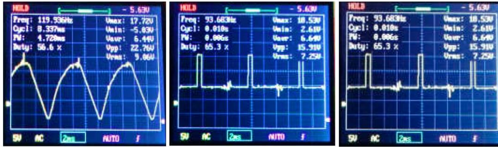
Figura 4. a) Reducción de señal b) Rectificación de puente de diodos c) Salida de señal en pulsos
